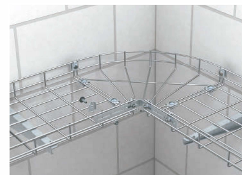
Montaje de una curva para bandeja de rejilla Montaje de una curva para bandeja de rejilla preparada por medio de uniones rectas GSV 34 y cinta perforada curvada.
