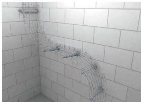
Curvas ascendente y descendentes Mediante un corte de una de las barras laterales de la bandeja de rejilla se pueden realizar codos verticales ascendentes y descendentes.
