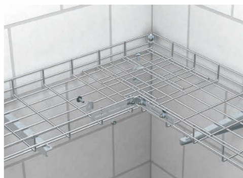
Creación de un ángulo para rejilla - de esquina, a solape Tras el correspondiente corte de las bandejas de rejilla, estas pueden montarse con las uniones de punto de contacto GSV 34 y una cinta perforada doblada para crear una curva de bandeja de rejilla angular que se solape.
