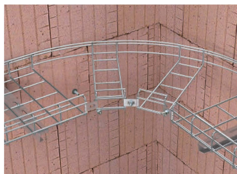
Curvas horizontales Realización de una curva horizontal para bandejas de rejilla C con unión curva GEV 36.
