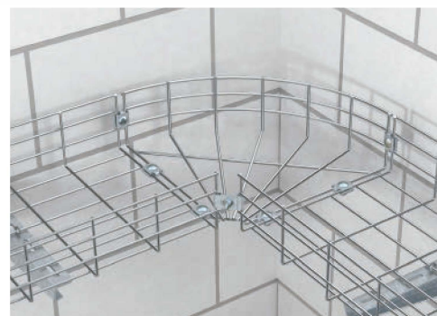
Montaje de una curva para bandeja de rejilla Montaje de una curva para las bandejas de rejilla GRB 90 con uniones rectas GSV 34 así como unión curva GEV 36.
