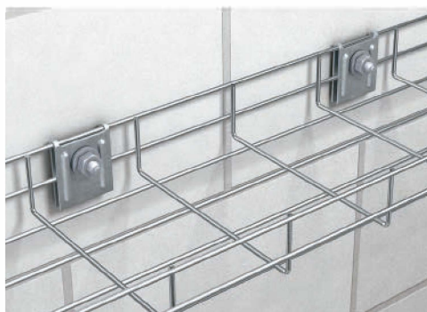
Fijación a pared de bandejas de rejilla Fijación a pared de bandejas de rejilla con soporte de pared K 12 1818. Ancho máximo recomendado de las bandejas de rejilla de 200 mm.
