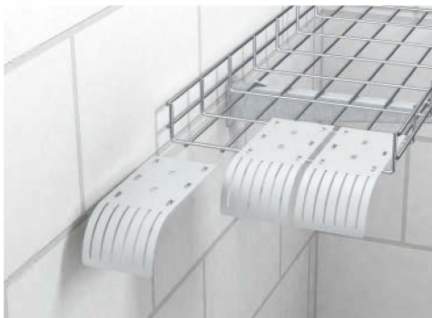
Bandeja de rejilla con chapa de salida de cables Chapa de salida de cables para el montaje sin tornillos en bandejas de rejilla. Con la chapa de salida de cables se pueden mantener radios de curvatura predefinidos.
